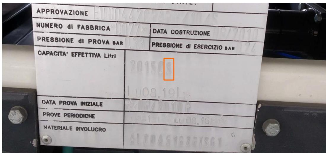
1. Ogni cisterna deve portare una targa di metallo resistente alla corrosione, fissata in modo permanente sulla cisterna in un punto facilmente accessibile per l'ispezione. Su questa targa devono essere marcati per punzonatura o altro mezzo simile almeno le seguenti informazioni. Queste informazioni possono essere impresse direttamente sulle pareti del serbatoio stesso, se le pareti sono rinforzate in modo da non compromettere la resistenza del serbatoio:
